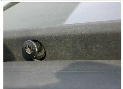
Remettre les 4 vis TORX de diamètre 40
